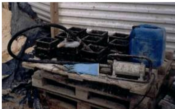
Figura 1 - Vibrador de agulha e moldes.
