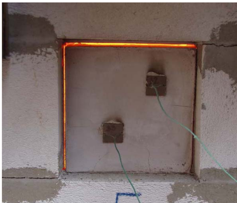
Figura 3 – Placas obtidas por activação alcalina sujeitas a fase térmica. São visíveis dois termopares aplicados na face posterior da placa (Perná et al., 2007)
