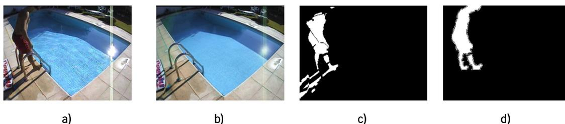
Figura 2.9.16: Comparação entre a imagem capturada e o *background* estimado e entre o mapa binário de *foreground* e o mapa binário de referência, numa cena afectada por uma reflexão especular muito intensa, capaz de causar a saturação do CCD.
