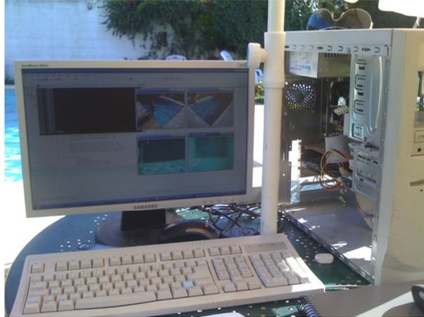
Figura 5.1.1: Máquina utilizada na gravação sincronizada das quatro câmaras analógicas. Na imagem pode ser vista a execução do software responsável pela captura e armazenamento do vídeo.
