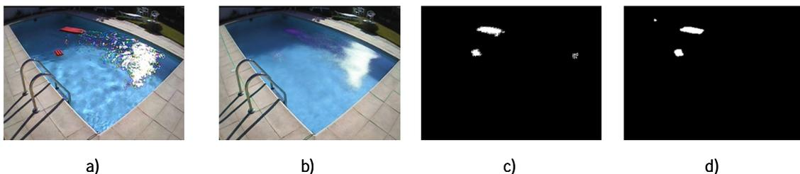
Figura 2.9.19: Comparação entre a imagem capturada e o *background* estimado e entre o mapa binário de *foreground* e o mapa binário de referência, numa cena afectada por uma reflexão especular muito intensa e espalhada pela superfície da água ocupando uma área significativa.
