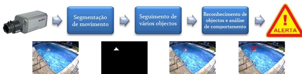
Figura 1.4.1: Arquitectura de software do sistema.
