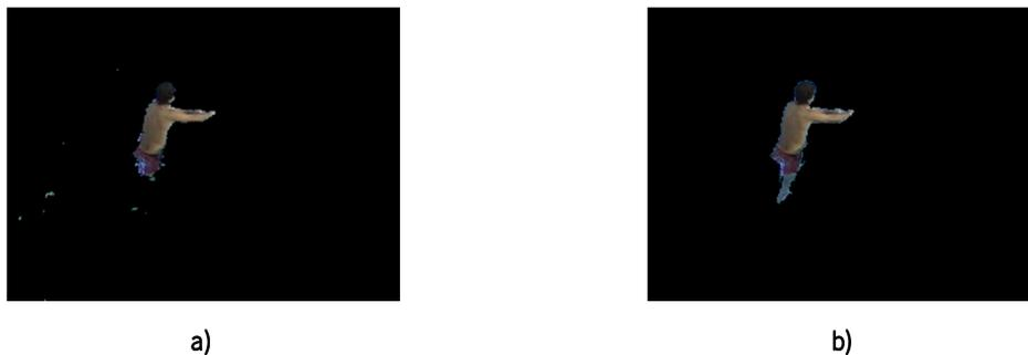
Figura 2.7.9: Comparação entre o mapa binário de *foreground* inicial e depois da re-segmentação. Houve um aumento efectivo da precisão do *foreground*, que é agora praticamente coincidente com o indivíduo, apanhando mesmo os pormenores, absolutamente necessários para o próximo estágio do *pipeline* de processamento. Além disso o nível de ruído foi também diminuído de forma significativa, reduzindo a percentagem de falsos positivos.
