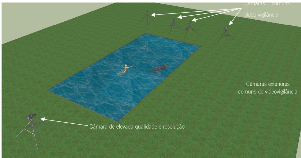
Figura 5.1.2: Disposição das várias câmaras utilizadas na gravação das imagens de referência para efectuar a prova de conceito. Uma das câmaras corresponde a um aparelho doméstico de gravação de vídeo com elevada resolução e qualidade. As restantes são câmaras comuns utilizadas em aplicações típicas de videovigilância, tendo portanto, menor qualidade de imagem e mais baixa resolução. Gerado com o *Google SketchUp*.
