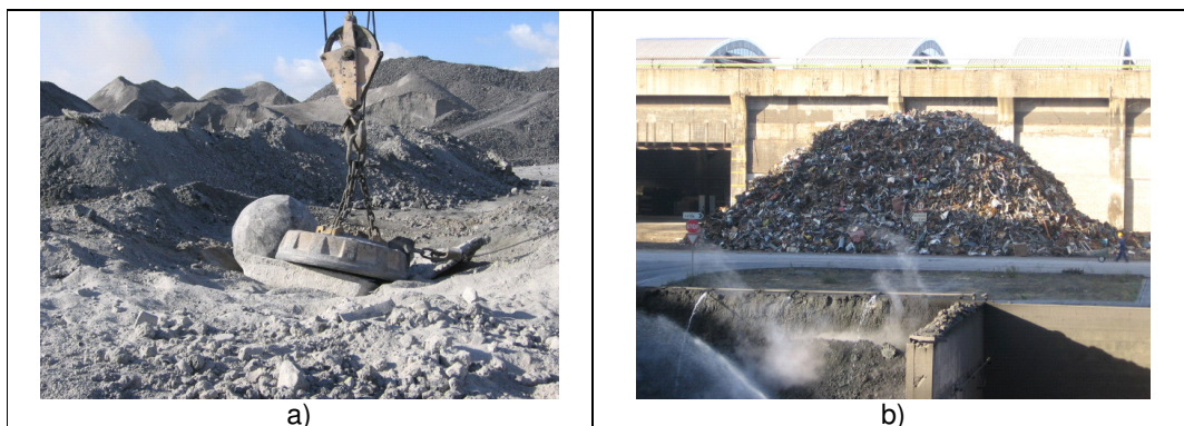
Figura 2.2: Processamento da escória de aciaria nacional: a) fragmentação; b) parte metálica restante após a separação das partes metálica e não metálica (Roque et al., 2006)
