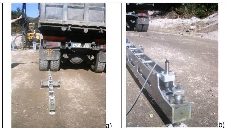
Figura 7.13: Ensaio de carga com pneu: a) Vista geral; b) Pormenor do transdutor
