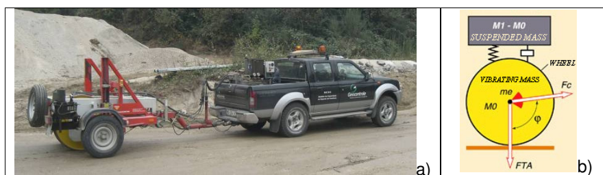
Figura 7.18: Portancemètre : a) aspecto geral; b) esquema de funcionamento
