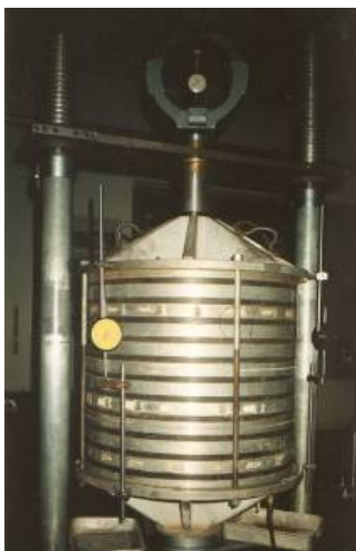
Figura 4.10: Câmara, E50, utilizada no ensaio de compressão unidimensional
