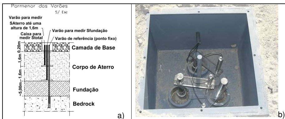
Figura 7.6: Varões extensométricos: a) Pormenor da localização; b) Instrumentação
