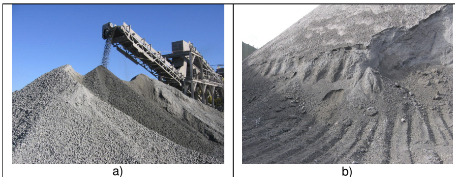
Figura 2.3: Processamento da escória negra nacional: a) Peneiração em fracções granulométricas; b) Armazenamento e maturação por hidratação ao ar livre (Roque et al., 2006)
