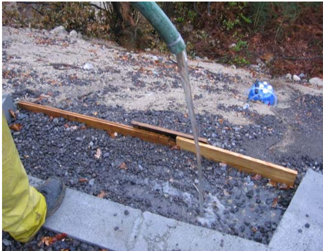
Rega do ASIC com água na plataforma de infiltração situada a 1,4 m do topo do lisímetro
