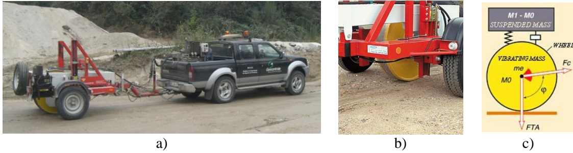
Figura 4 – “Portancemètre”: a) aspecto geral; b) detalhe da roda vibrante; c) esquema de funcionamento
