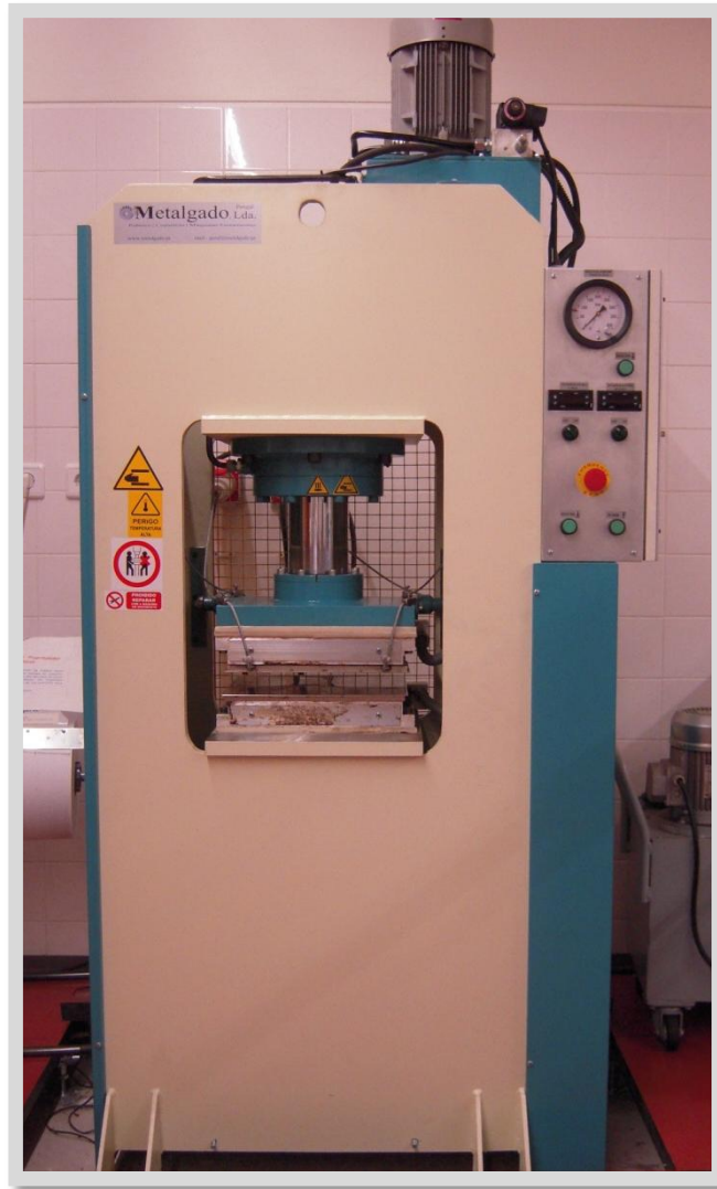
Figura 3.6: Fotografia da prensa hidráulica utilizada na preparação de amostras.
