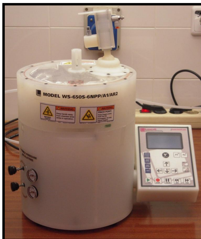
Figura 3.2: Fotografia do spin coater utilizado na preparação das amostras de PANI.
