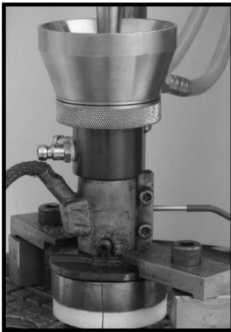
Figura 3.5: Fotografia da mini-extrusora utilizada no processo de extrusão [14].
