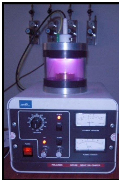
Figura 3.9: Fotografia do sputter coater utilizado na deposição dos eléctrodos.
