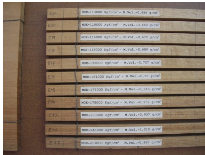
Figura 4.89 – Amostras de eucalipto tiradas sequencialmente de uma mesma prancha na direcção radial completa, para ensaios de flexão.
