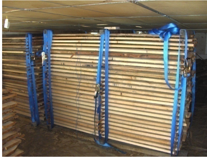
Figura 4.4 – Secagem de pranchas de eucalipto sob condições controladas num secador solar e sob forte restrição mecânica.
