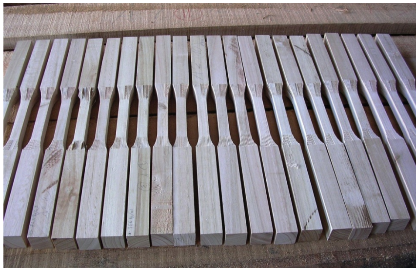
Figura 4.5 – Preparação intermédia de provetes para ensaio de tracção paralela às fibras.
