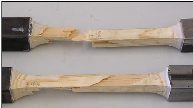
Figura 4.15 – Exemplos das formas de ruptura no ensaio de tracção paralela do pinho bravo, essencialmente por corte paralelo nas camadas de lenho inicial.
