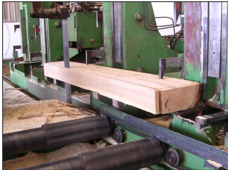
Figura 4.3 – Serragem orientadas dos toros de eucalipto, para obtenção de maior número de pranchas de corte radial.
