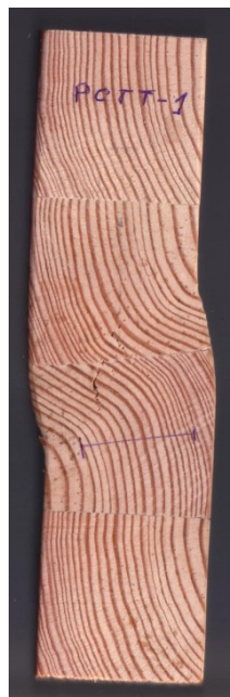
Figura 4.79 – Estado de deformação por compressão transversal do pinho bravo até à carga máxima.
