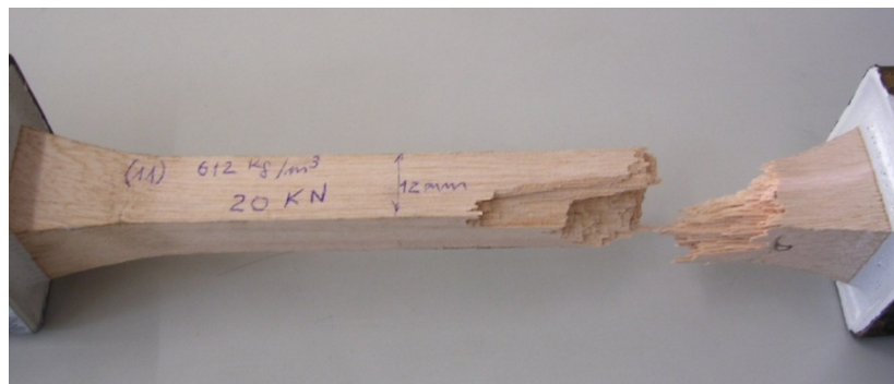
Figura 4.21- Ruptura frágil do eucalipto de menor densidade, no ensaio de tracção paralela às fibras (Ref. 07.05.16 (11)).
