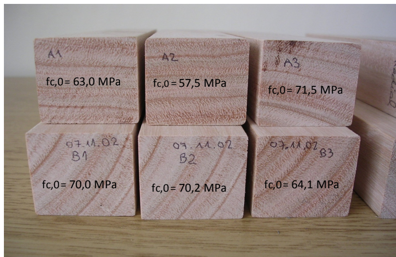
Figura 4.32 – Valores de tensão máxima à compressão paralela do eucalipto, provetes de zonas diferentes de uma mesma prancha.
