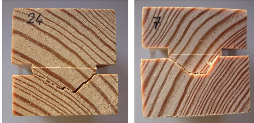
Figura 4.56 – Desvio da superfície de fractura no corte paralelo. Tensão de corte numa secção de superfície mais estreita.
