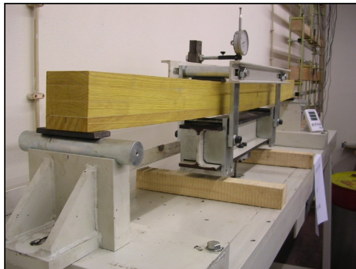
Figura 4.104 – Detalhe da mesa de ensaios de fluência com o provete de lamelado de pinho bravo.
