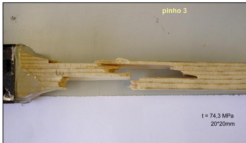
Figura 4.14 – Exemplo de ruptura por tracção paralela do pinho bravo ( \gamma = 470 \text{ kg/m}^3 ). (Ref. Pin3 2004-07-07).
