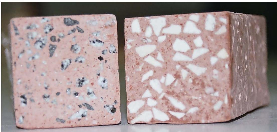
Figura 2 – Argamassa de ligante activado alcalinamente a partir de resíduos de minas
