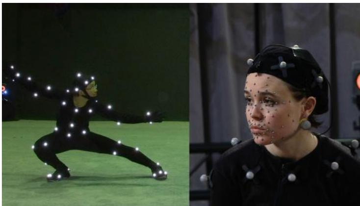
*Figura 2 - Sistema de captura óptico con marcadores pasivos [7].*
