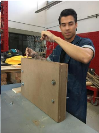
Fig. 4 Colocación de armado
