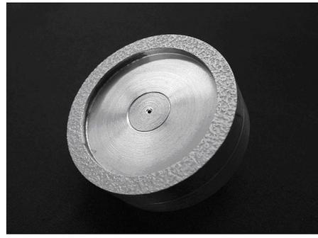
Figura 4 – Corpos padrão **SMB** com 0,1 µm para Ra (esquerda) e **TMB** (direita) adoptados para o equipamento FRICTORQ I
