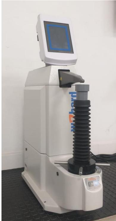
Figura 4 . Durómetro *Mitutoyo HR-522/522L*
