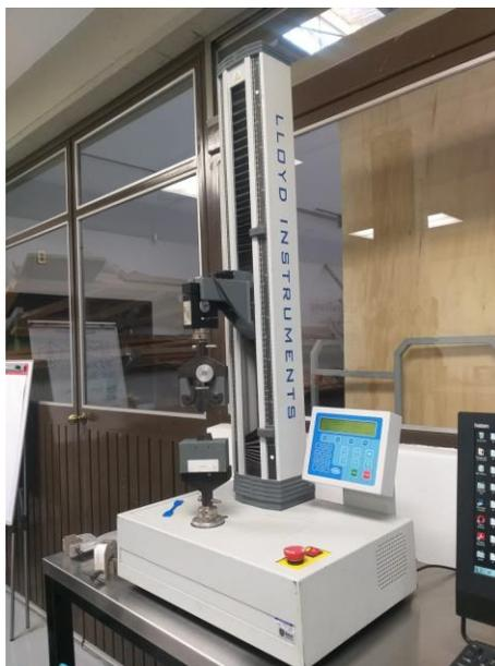
Figura 3. Prensa Universal Lloyds con capacidad de 500 kg
