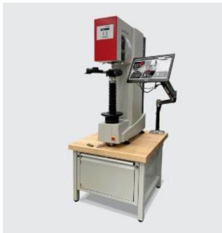
Figura 1. Durómetro [16]
