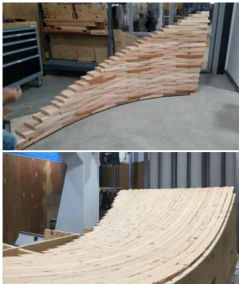
Figura 2 y 3. Propiedades superficiales de NLT (Countesy of Perkins + Will).
