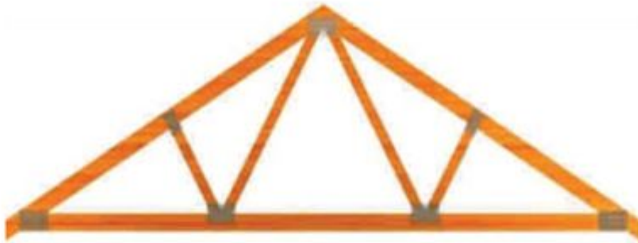
Figura 55. (UNAM, s.f.). Estructura de techumbre armada con placas metálicas dentadas.
