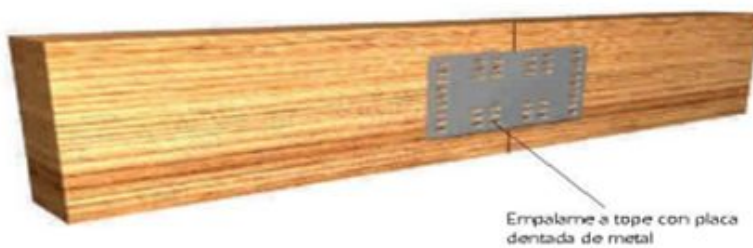
Figura 87. Empalme a tope mediante placas dentadas
