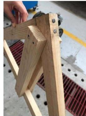
Las herramientas utilizadas en la elaboración de la estructura fueron clavos y un martillo. Se decidió realizar un ensamble sencillo conectando dos tramos de madera formando un ángulo de 90 grados y colocamos dos soportes transversalmente para brindar mayor resistencia a la estructura.
