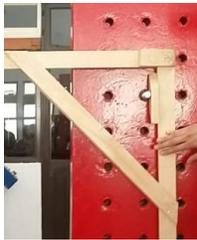
M-No. 2 : Falla estructural en el vértice de unión de las dos piezas, y en la parte media de los listones de madera, el marco resistió 46 kg pero no colapsó, el balde con peso todo el piso.
