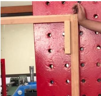
La tercer estructura fue una conexión fue una estructura simple sin ningún refuerzo, la parte vertical era mayor tamaño que la horizontal por lo que a la primer presencia de peso se vio la falla separando la unión hasta que logró vencerla.
