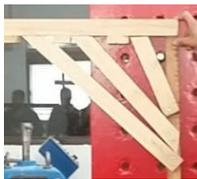
M-No. 5 : el triple refuerzo de esta estructura le dio buen refuerzo para superar los 30 kg, el método no es estético y genera más gasto de material por un poco de resistencia
