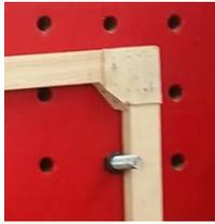
M-No. 7 : Esta estructura simple y ligera dio una buena resistencia a pesar de ser sencilla esto debido a unión con cortes a 45 grados, reforzada en el interior con clavos y reforzada con una placa de triplay que unia las placas por ambos lados
