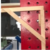
M-No. 1 : Falla estructural en el vértice de unión de las dos piezas, debido al desprendimiento de los clavos.
