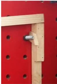
M-No. 3 : Falla estructural en el vértice de unión de las dos piezas, la unión era simple y el soporte reforzado con clavos no resistió
