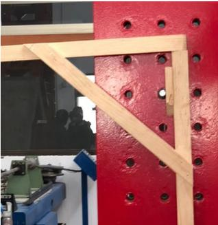
La primer estructura que se realizó presentó un fallo en la unión del nodo, esto generó el giro de los clavos. separando la parte horizontal de la vertical. Sin embargo se mantuvo unida de la diagonal de refuerzo.
