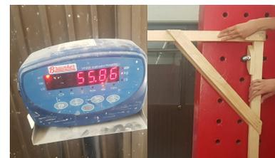
Otra de las estructuras que se realizó durante la clase tiene de igual manera una sola diagonal, sin embargo esta se encontraba reforzada por ambas partes, y se unían por la parte de atrás y adelante.
