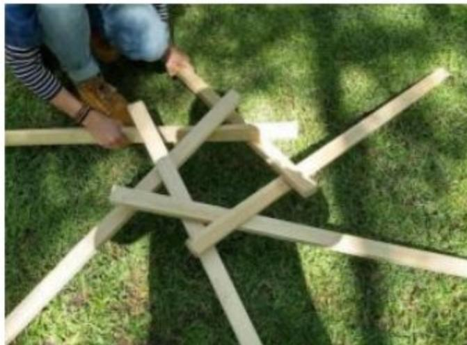
Logrando distintas configuraciones de marcos recíprocos y orientando los elementos en la dirección que sean más eficientes, es decir, en su inercia fuerte, se puede lograr un sistema apto para resistir demandas de carga importantes, como se muestra a continuación.
