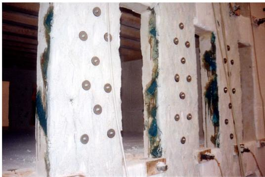
c) Pormenor dos conectores metálicos e da colagem lateral das faixas de fibras de vidro
