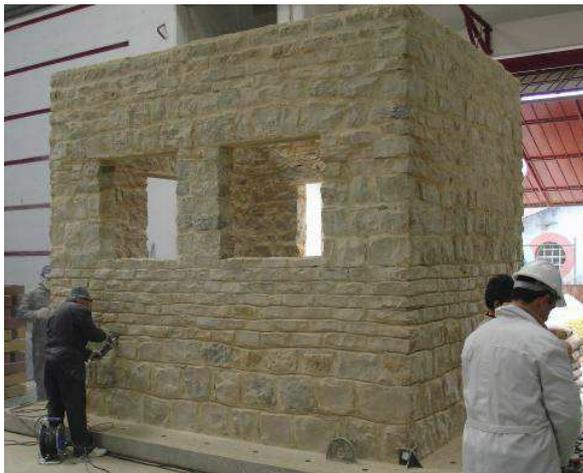
a) Preparação da superfície da parede
