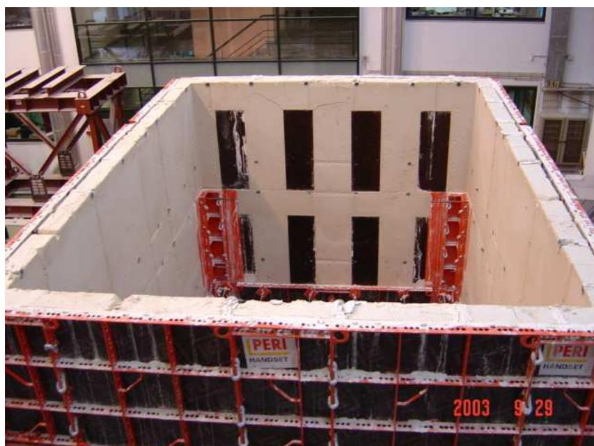
Figura 3.14 – Remoção da cofragem do Modelo 3
