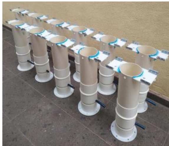
Figura 5. Pluviómetros terminados en aspecto mecánico.
