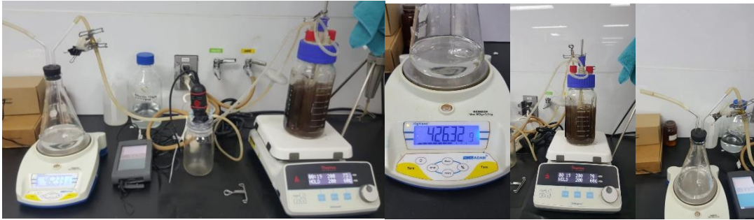
Figura 37. A) Sistema de BTA utilizado para comprobación de \text{CO}_2 como representante de producción de biomasa en el cual se aprecia también B) el sistema de medición de \text{K}_2\text{CO}_3 producido mediante a cambios el peso en la trampa de potasa, C) el BTA Schott DURAN empleado en el cultivo y D) la trampa de potasa.
