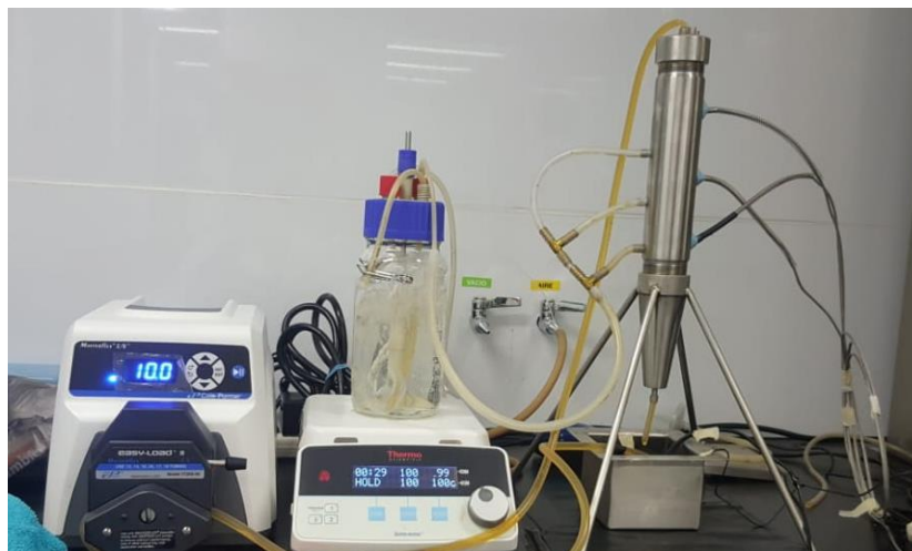
Figura 42. Sistema de caracterización térmica para BLPR MBQ con implementación de aire húmedo y a temperatura de 34°C utilizando un frasco Schott Duran y una termobalanza con control Thermofisher.
