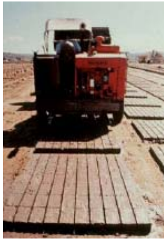
Figura 4 – Fabrico de adobes de forma mecânica
