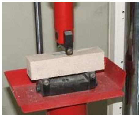
Figura 1 – Ensaio de flexão sobre um prisma de argamassa geopolimérica (AGP) [Osório, 2006]
