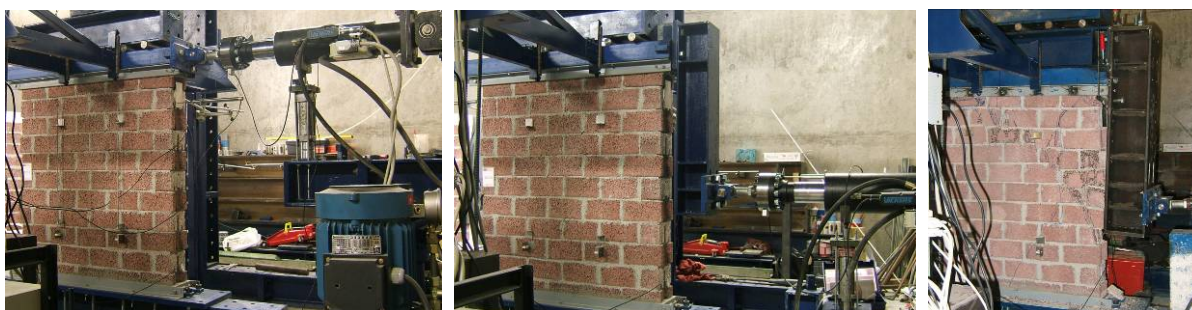
Figura 7: Adequação do sistema de ensaio (nível do actuador horizontal e perfis metálicos) no ensaio de teste.
