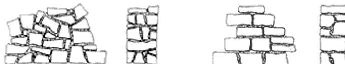
Figura 2 – Paredes de pedra irregular (à esquerda) e de pedra regular (à direita) [3]
