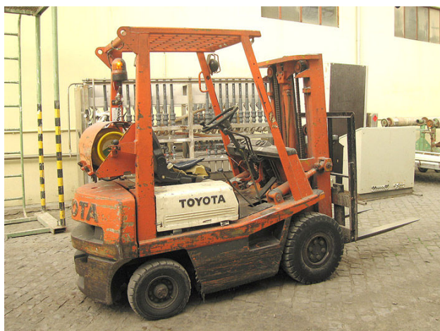
Figura 7.2 – Empilhador com sirene identificadora de marcha-atrás.
