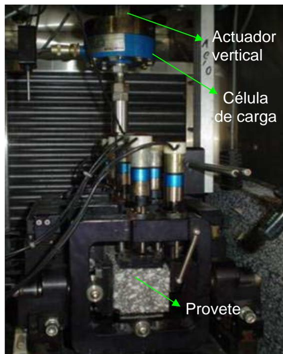
Figura 4 – Dispositivo para ensaio de fadiga de flexão em 4 pontos
