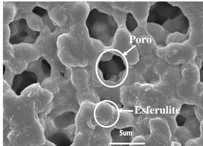
Figura 5.2 - Imagem de SEM para a amostra de \beta -PVDF obtida por solução.
