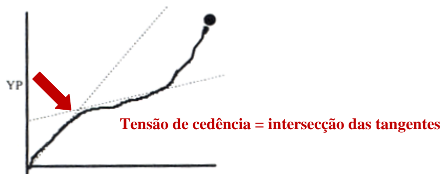
Figura 3.30 - Ilustração da determinação do ponto de cedência.
