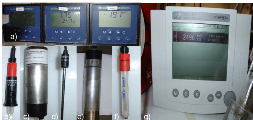
Figura 3-9 Sensores e monitores utilizados durante a operação da instalação laboratorial. (a) monitores (296 R/RS - WTW) utilizados para os sensores de pH, temperatura, oxigénio dissolvido e potencial redox; (b) sensor pH; (c) sensor oxigénio dissolvido; (d) sensor temperatura; (e) sensor sólidos dissolvidos; (f) sensor potencial redox e (g) monitor para sensor de sólidos dissolvidos (MIQ/S 184-H3 - WTW).
