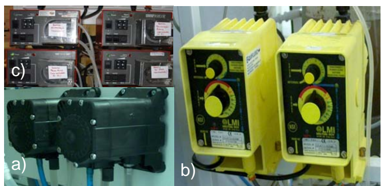
Figura 3-12 Bombas utilizadas na instalação laboratorial (a) bombas Flojet; (b) bombas doseadoras electromagnéticas e (c) bombas peristálticas.
