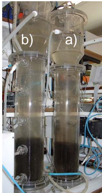
Figura 6-7 Reactor anaeróbio (a) e anóxico (b) inoculados com biomassa anaeróbia granular.
