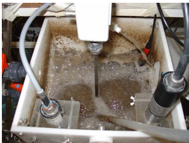
Figura 6-13 Aspecto do reactor arejado durante a operação da instalação.
