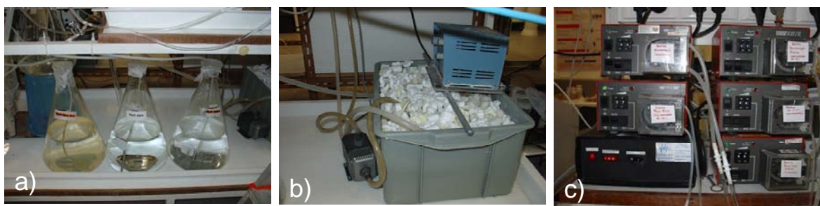
Figura 3-6 a) Alimentação da instalação; b) Banho termostatzado; c) Bombas de alimentação da instalação.
