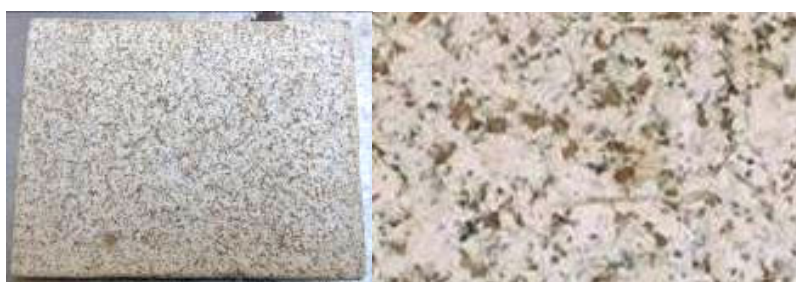
Figura 11 – Placas de pasta de papel e granulado de cortiça reforçadas com fibras de cânhamo. a) aspecto geral da placa e b) textura da placa (escala 1:1).
