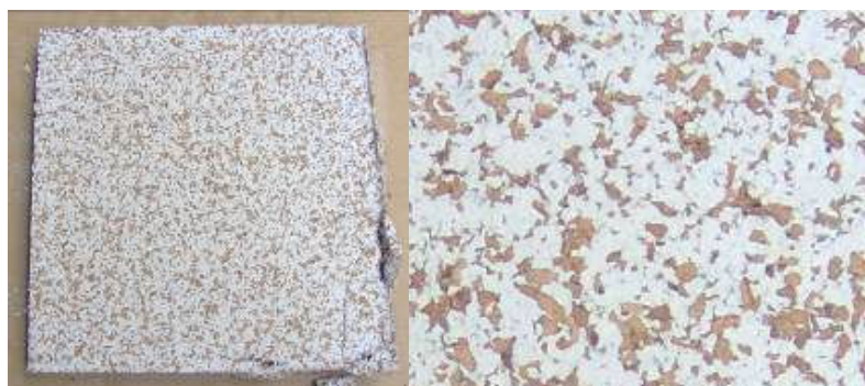
Figura 12 – Placa de pasta de papel e granulado de cortiça após a cura. a) aspecto final da placa e b) textura da placa (escala 1:1).
