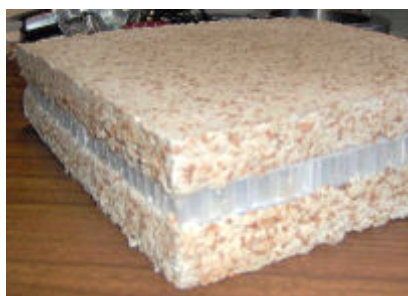
Figura 13 – Placa sanduíche de pasta de papel/cortiça e favo de abelha PP.
