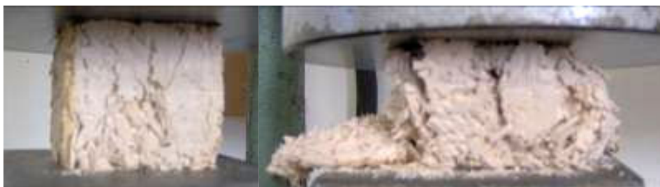
Figura 7 – Comportamento à compressão do compósito de cânhamo - a) durante a rotura inicial e b) após a rotura.
