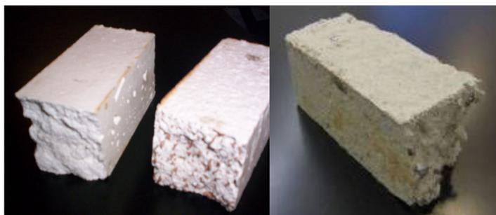
Figura 1 – Pastas de gesso com fibras de celulose, granulado de cortiça e fibras têxteis.
