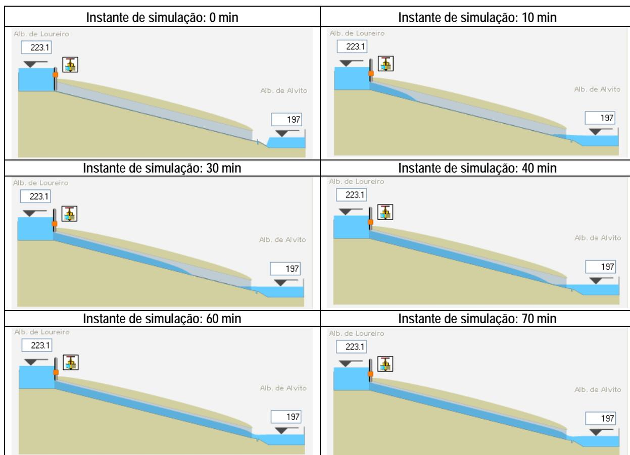
Figura 9 Modelo hidrodinâmico da ligação Loureiro – Alvito. Simulação da abertura da comporta.
