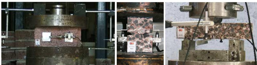
Figura 2 – Ensaios de compressão e de tracção directa e por flexão em blocos.
