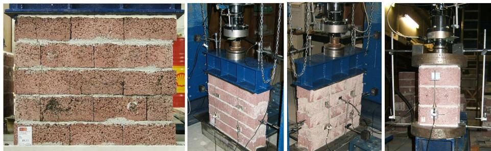
Figura 5: Esquema de rotura e ensaios à compressão em paredes e de prismas.
