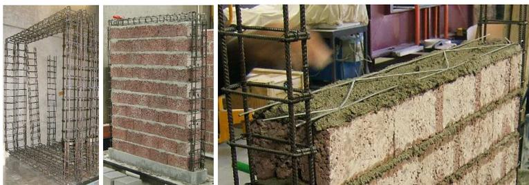
Figura 4 – Armaduras de confinamento e de junta horizontal.
