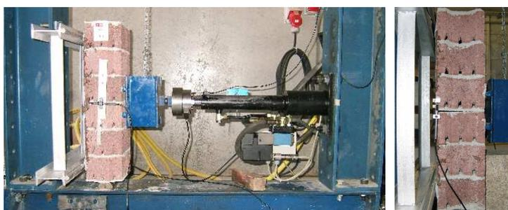
Figura 6 – Realização de ensaio de flexão.
