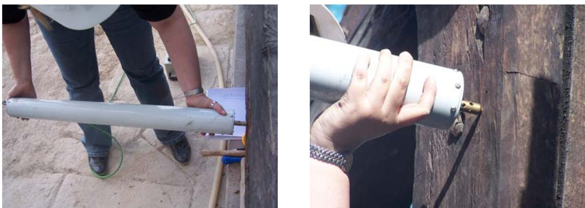
Figura 9 – Uso do Resistograph® na Tesoura 2
