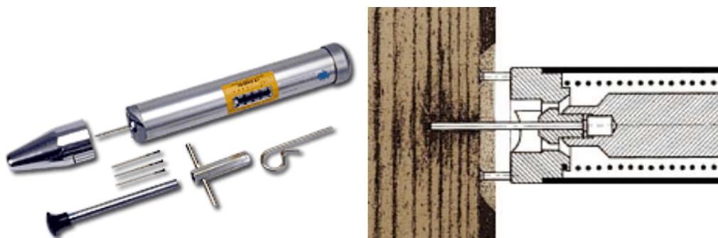
Figura 11 – Equipamento de penetração ao impacto Pilodyn®
