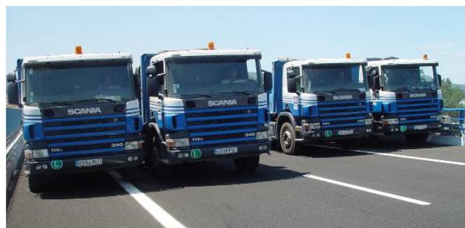
**Figura 14 – Realização do ensaio de prova de carga**
