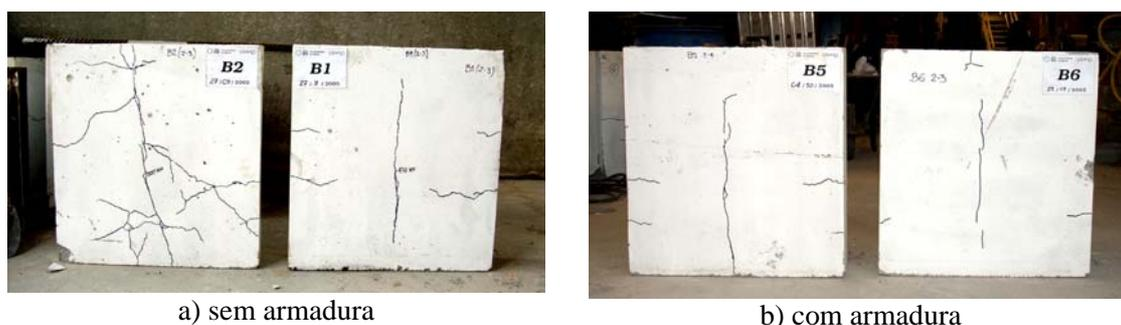
**Figura 9 - Fissuração das lajes em corpos-de-prova ensaiados.**
