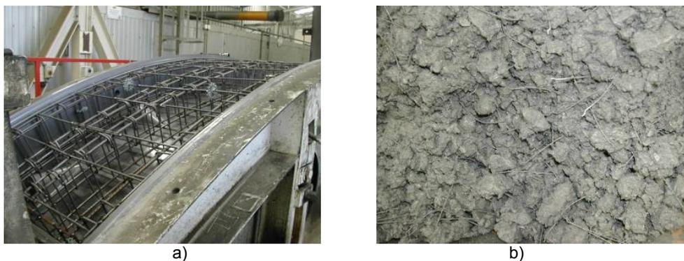
Figura 1: Substituição da armadura convencional por fibras de aço
