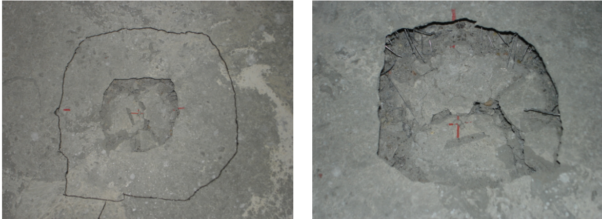
Figura 21 - Modo típico de rotura nos ensaios de punção
