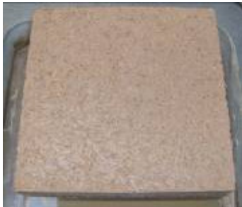
a) final hempcrete plate
