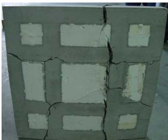
Figura 17 - Padrão de fendilhação do painel em BACRFA_30 no final do ensaio de flexão
