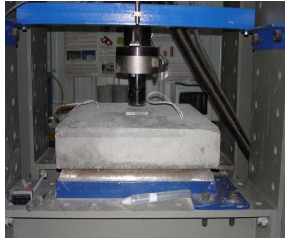
Figura 19 - Condições de apoio e configuração do carregamento do protótipo de painel
