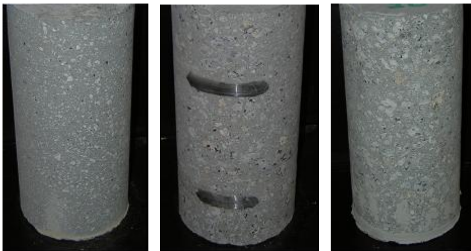
Figura 8 – Carotes extraídas dos painéis betonados com BAC: topo (à esquerda); meio (ao centro); fundo (à direita).
