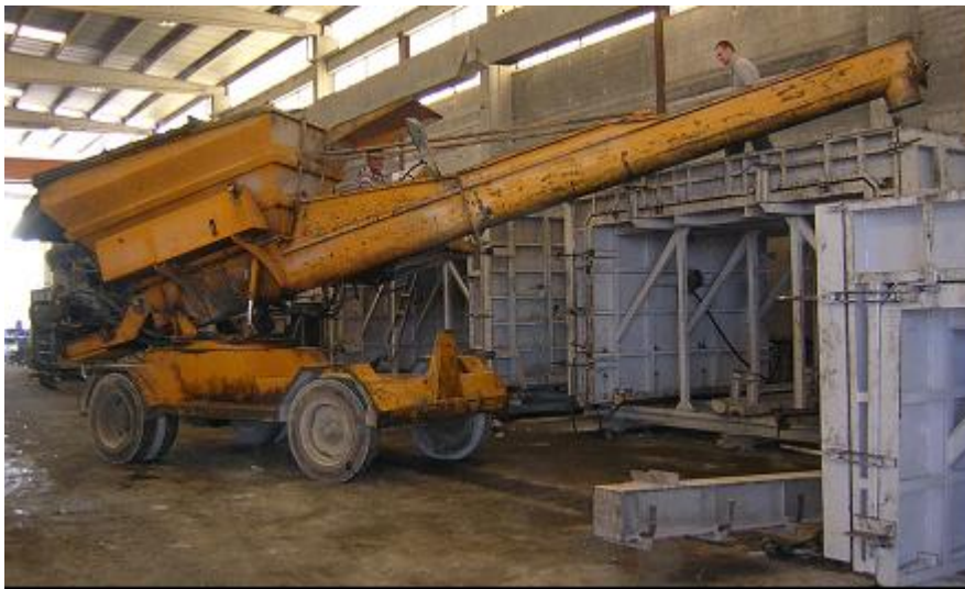
Figura 4 – Veículo de transporte e descarga do betão.
