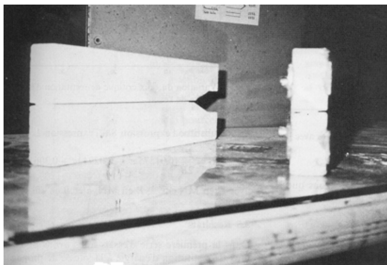
Figura 3: Caminho de fissura e reforço exterior dos provetes.
