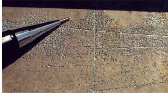
**Figura 4.2 – Corrosão por “picadas”.**
