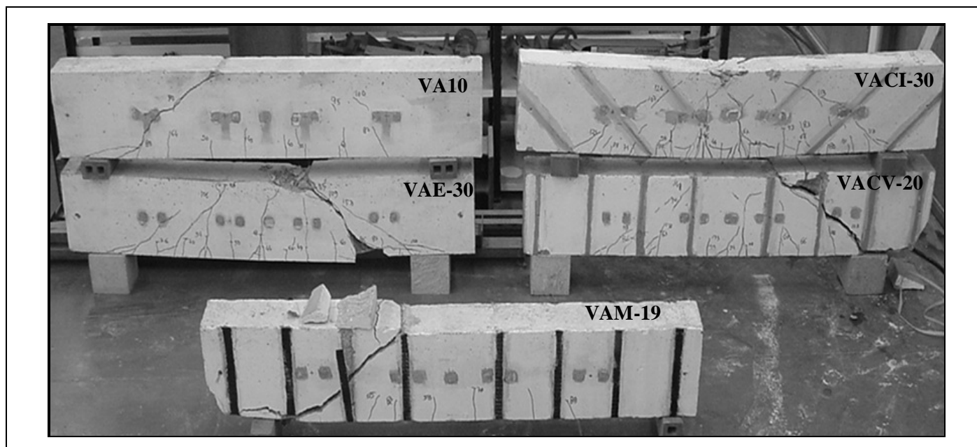
Figura 8 - Modos de rotura das vigas da série A com 4φ10 longituginais.
