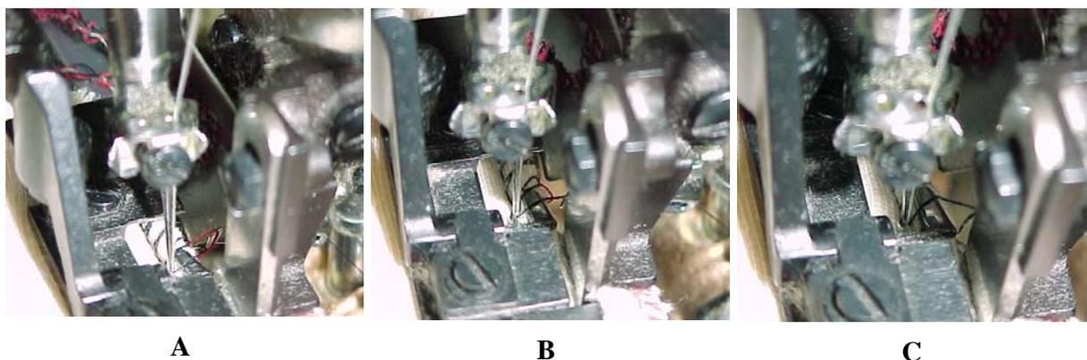
Figura 3 - Posição dos vários elementos durante a ocorrência do segundo pico de tensão absoluta nas três linhas num ciclo da máquina de costura (A – P2Ag (305°); B - P2Li (305-320°); C - P2Ls (340 - 345°)).
