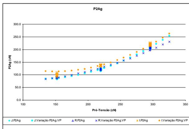
Figura 6 - Variação da tensão para o segundo pico de tensão na linha da agulha em função da pré-tensão na linha da agulha e dos valores da tensão gerados nas outras linhas (*variações VP*) para as estruturas jersey, rib e interlock.
