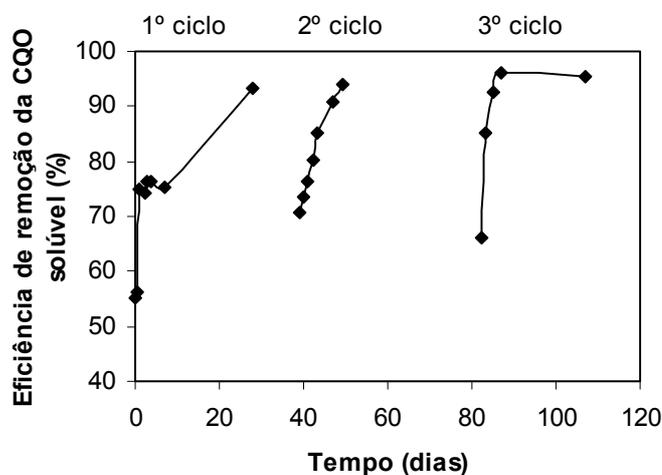
Figura 1 - Evolução ao longo do tempo da eficiência de remoção da CQO solúvel, nos três ciclos sucessivos.
