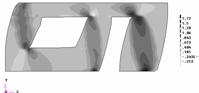
Figura 11 - Distribuição das tensões de cisalhamento na fase de pós pico – W+X - N/mm^2
