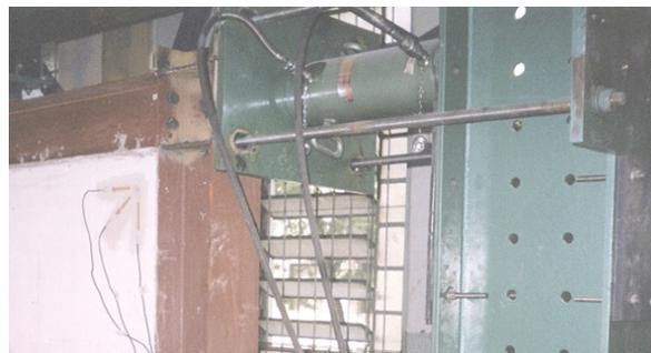
**Figura 9 - Sistema de aplicação de carga (cilindro hidráulico).**
