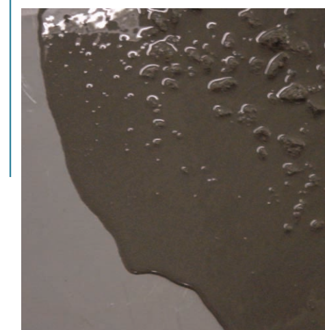
Fig. 11 - Pormenor da fronteira do círculo de betão espalhado
