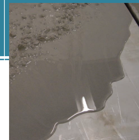
Fig. 11 - Pormenor da fronteira do círculo de betão espalhado
