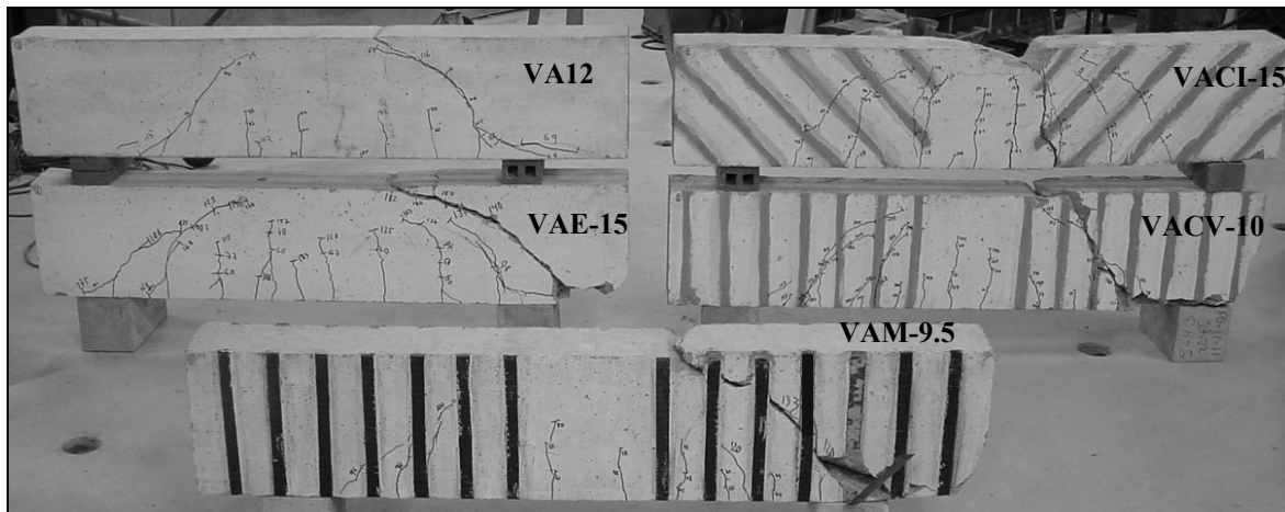
Figura 12 - Modos de rotura verificados nas vigas com 4 \phi 12 longitudinais.
