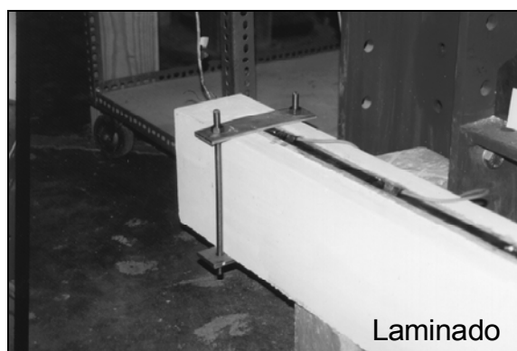
Figura 4 – Mecanismo exterior de fixação do laminado.
