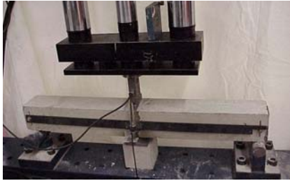
Figura 8 – Ensaio de flexão dos provetes prismáticos colados com argamassa epóxida
