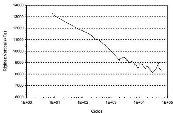
Figura 11 - Evolução logarítmica da rigidez vertical na zona da fenda durante um ensaio de reflexão de fendas
